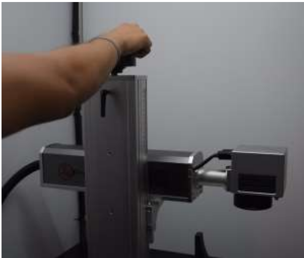
Ilustración 7. Manivela que ajusta la altura del cañón.
