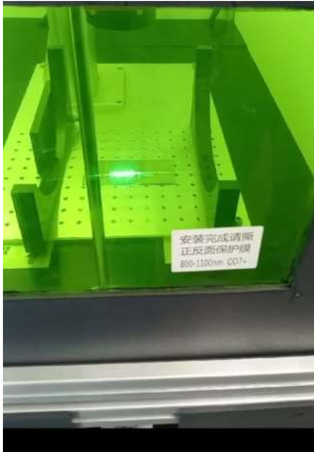
Ilustración 20. Emisión de láser en fase de marcado.
