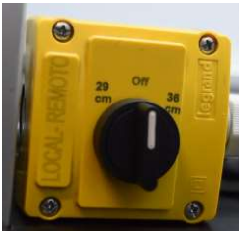
Ilustración 9. Interruptor de cambio
