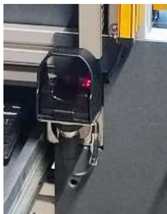
Imagen 8. Limpieza de sensores Banner con paño seco. (Eliminar polvo)
